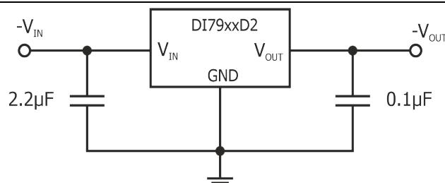
**Fig. 1** Typical application circuit for DI79xxD2**Fig. 1** Typische Anwendungsschaltung für DI79xxD2**Dimensions - Maße [mm]**
